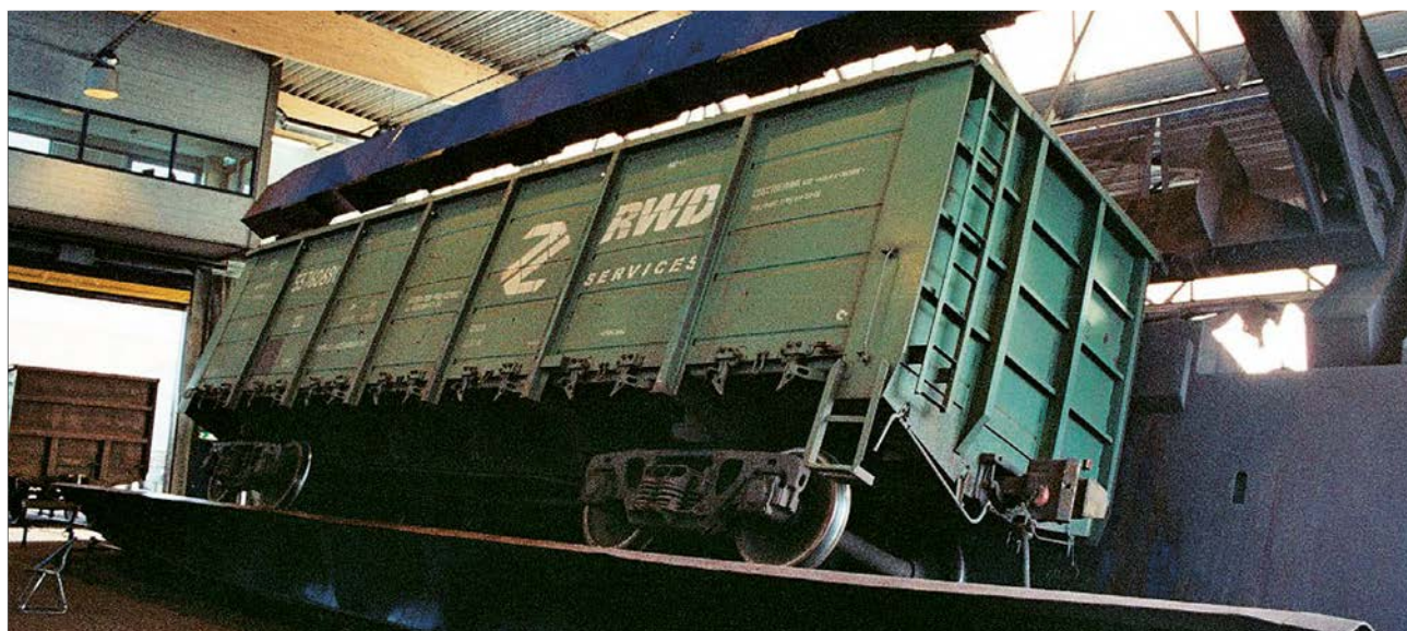
The train wagons are tipped sideways to make it easier to handle cargo in the port. Боковое опрокидывание вагонов облегчает процесс обработки грузов в порту.
